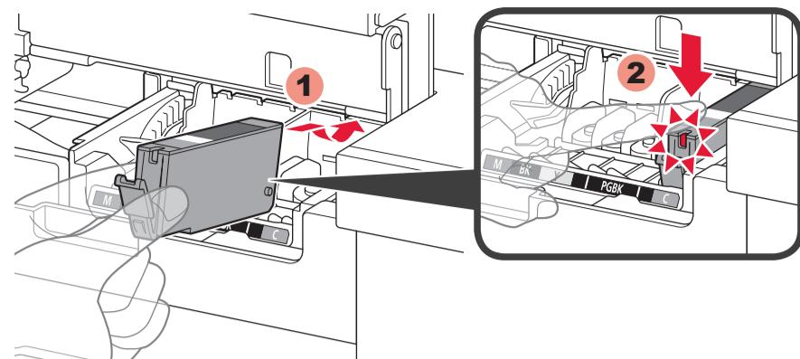
4 将墨水盒插入并向下推动至匹配颜色插槽。
