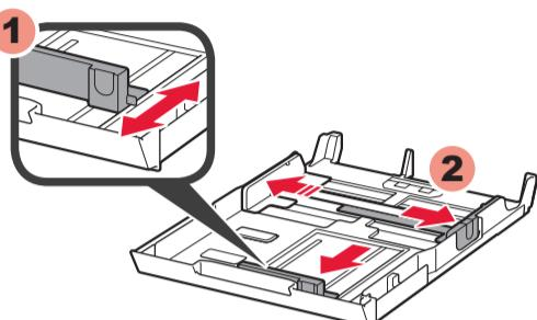
2 调整前端纸张导片以适合A4尺寸。
